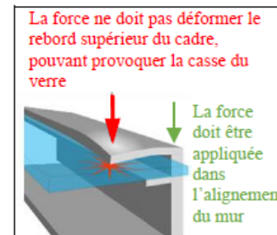
Figure 1a : Position de la Force de serrage de la bride
